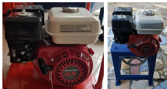
Gambar 8. Komponen mesin penggerak beserta dudukannya
